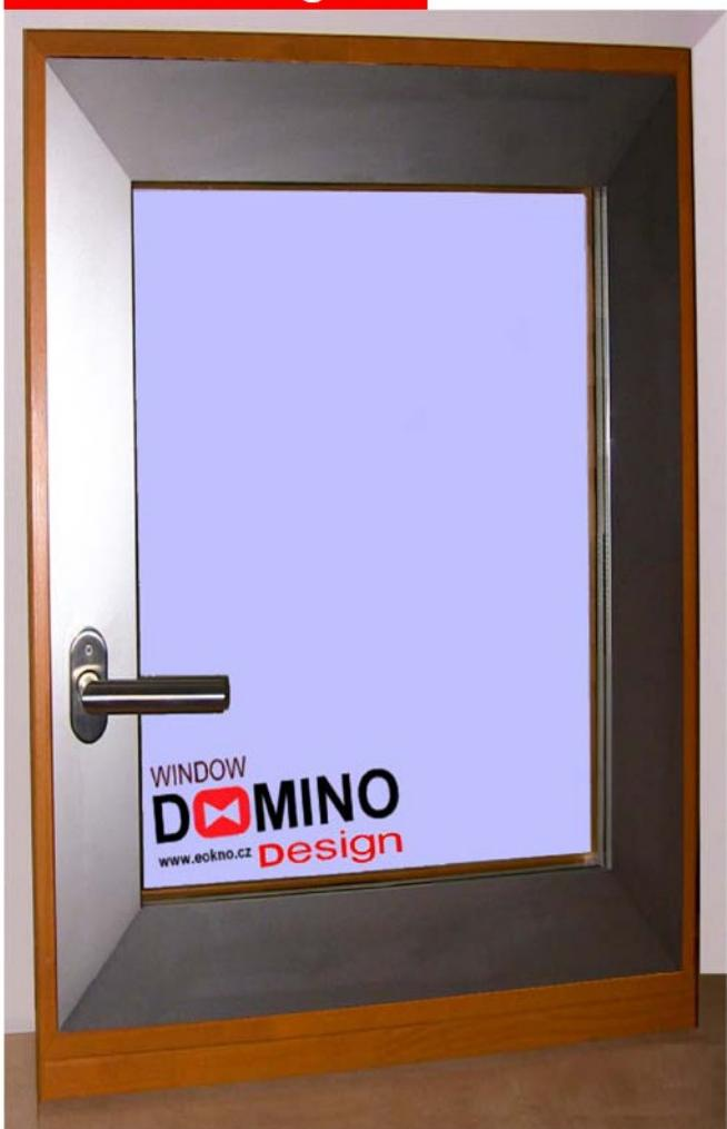
V unikátní konstrukci **DOMINO Design** je použita nerezová lišta ve dvojím provedení v šířce 75 mm překrývající celé křídlo v interiéru a v šířce 44 mm částečně, což umožňuje využití eurookna jako výrazného designového prvku, který je možno interiérově sladit.
